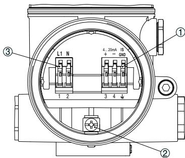
Отсек подключения (двухкамерный корпус)
